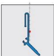
Anwendung: Durch das Aufsteckprofil wird verhindert, dass die Putzbeschichtung Kontakt zur Sockelschiene erhält. Damit werden Rissbildung und Auffrierungen verhindert.
