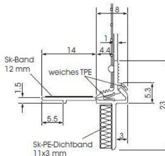
**Anwendung:** Vorbaurolladensysteme werden eingebaut, um Kältebrücken zu vermeiden. Die Revisionsblenden liegen aussen und der Putzanschluss erfolgt seitlich an den Führungsschienen.
