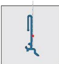
Anwendung: Durch das Aufsteckprofil wird verhindert, dass die Putzbeschichtung Kontakt zur Sockelschiene erhält. Damit werden Rissbildung und Auffrierungen verhindert.
