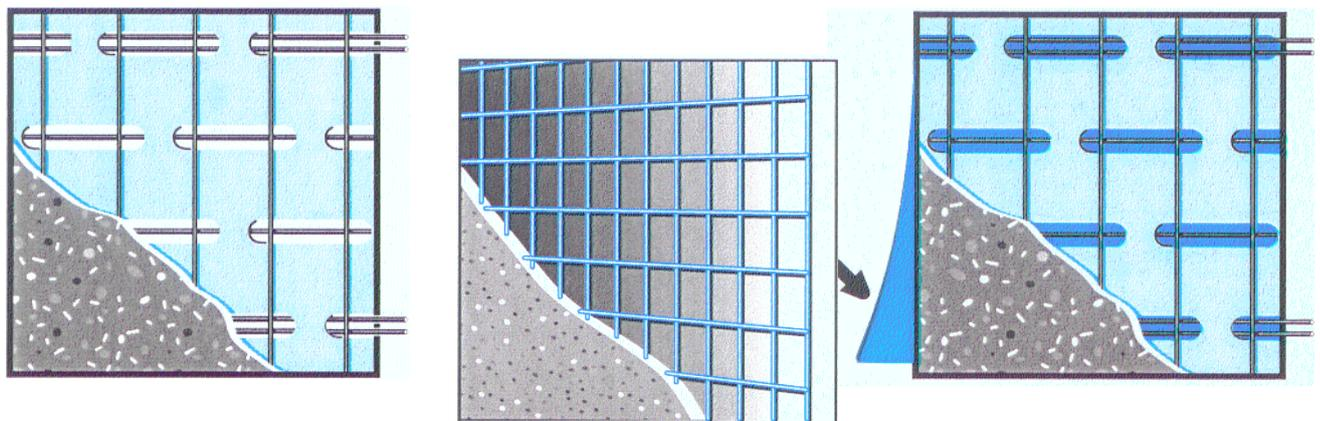
**Putzarmierungsgitter (Putzträger):** Diese Drahtgitter werden als Armierung für mineralische Putze im Bereich rissegefährdeter Zonen eingesetzt. Neben der Armierungsfunktion haben sie auch noch eine putztragende Funktion. Das Drahtgitter wird vor allem für das vollflächige Überspannen von gerissenen Fassaden verwendet.
