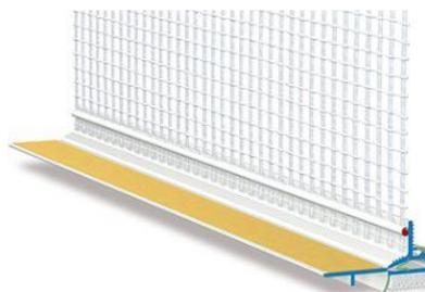
**Anwendung:** Die Gewebeleiste ermöglicht den flexiblen Putzanschluss an Vorbauroll-laden mit Revisionskasten und auf Bordprofilen der Fensterbank. Über eine TPE-Schleife werden dynamische Bauteilbewegungen aufgenommen, die durch Verformung und Ausdehnung entstehen.
